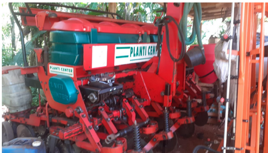
Figura 6 – Semeadora-adubadora 05 Planti Center PC 5/3 2006. Coronel Freitas (SC), 2022
