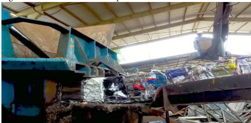
Figura 3 – Sucatas de ferro compactadas
