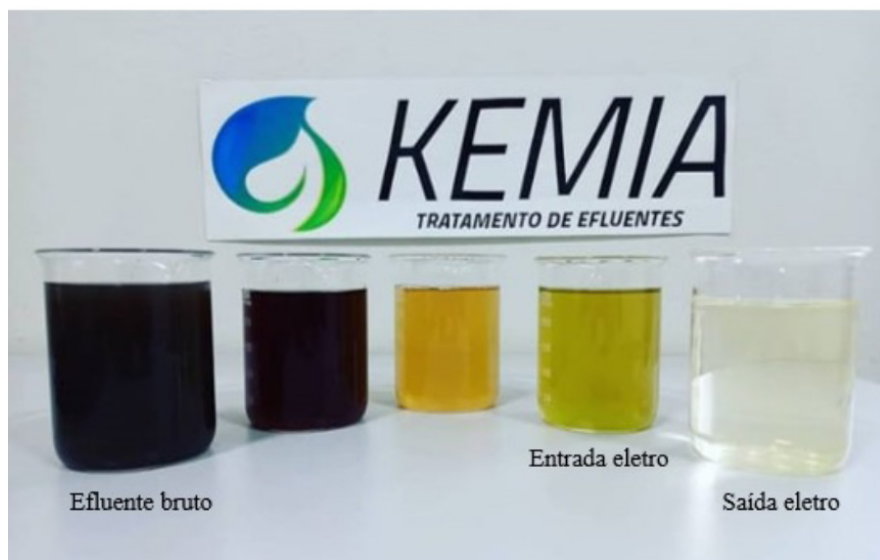
Figura 4 – Eficiência da estação de tratamento de efluentes de aterro sanitário
